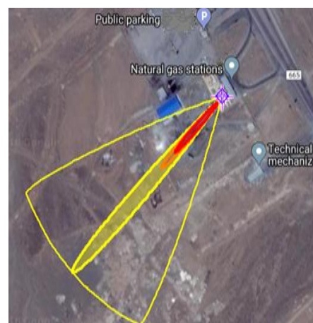
شکل ۳: محدوده بخار قابل اشتعال ناشی از سوراخ با قطر ۳ سانتی متر
