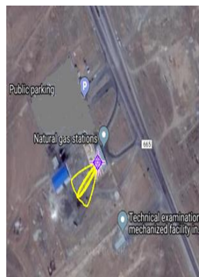
شکل ۱: در این سناریو محدوده زرد رنگ (PAC-1)، در حدود ۵۵ متری اطراف مخزن که غلظت ابر بخار سمی در این ناحیه ۶۵۰۰۰ ppm توسط نرم افزار برآورد شد.
