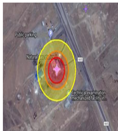
شکل ۶: منطقه تهدید تابش حرارتی (ناشی از شکاف با طول ۲۰ و عرض ۱ سانتیمتر)
