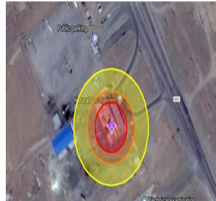
شکل ۵: منطقه تهدید تابش حرارتی (ناشی از سوراخ ۳ سانتیمتر)
