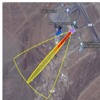
شکل ۴: محدوده قابل اشتعال ابر بخار متان (شکاف با طول ۲۰ سانتی متر)
