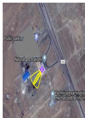
شکل ۱: در این سناریو محدوده زرد رنگ (PAC-1)، در حدود ۵۵ متری اطراف مخزن که غلظت ابر بخار سمی در این ناحیه ۶۵۰۰ ppm توسط نرم افزار برآورد شد.
