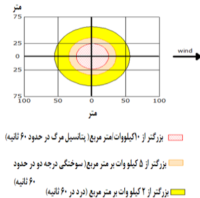
شکل ۵: منطقه تهدید تابش حرارتی (ناشی از سوراخ ۳ سانتیمتر)
