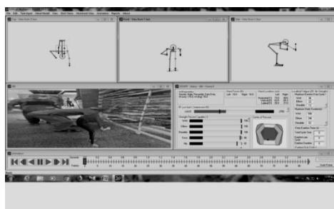
تصویر ۲: پوسچر شبیه سازی شده کارگر در حال بلندکردن بار در نرم افزار 3DSSPP
