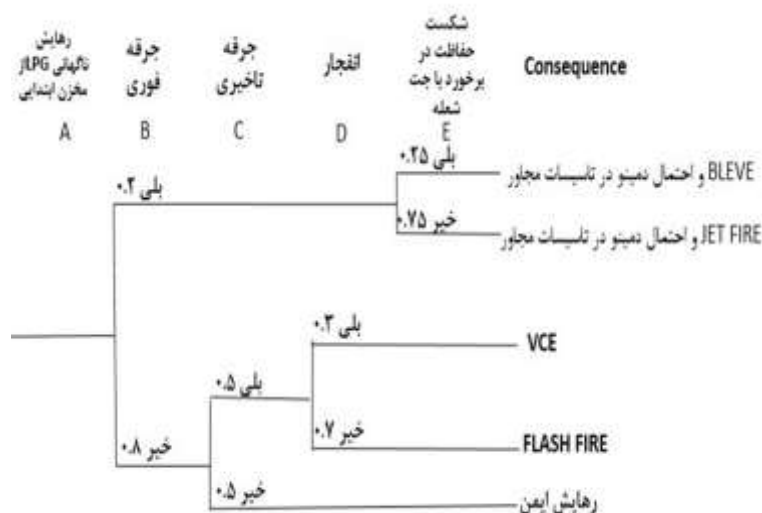
شکل ۲: درخت رویداد ترسیم شده مربوط به رهائش ناگهانی گاز LPG در روش Bowtie
