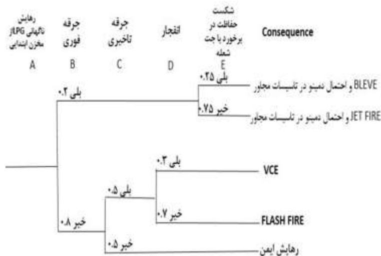
شکل ۲: درخت رویداد ترسیم شده مربوط به رهایش ناگهانی گاز LPG در روش Bowtie
