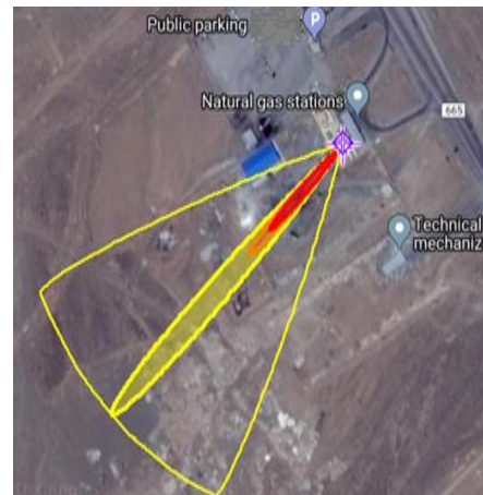
شکل ۳: محدوده بخار قابل اشتعال ناشی از سوراخ با قطر ۳ سانتی متر
